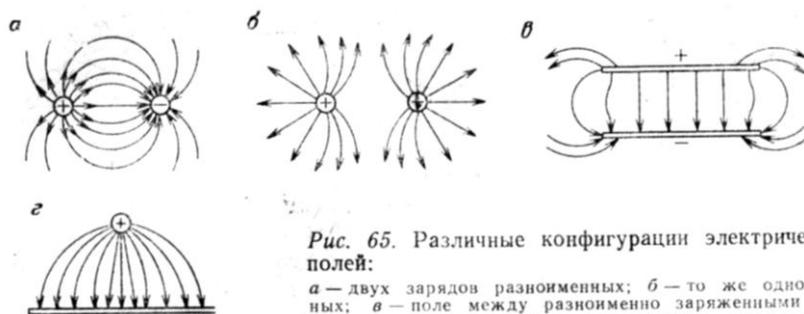
Рис. 65. Различные конфигурации электрических полей:
